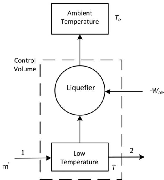
Fig. 7. Reversible gas cooler/liquefier.
