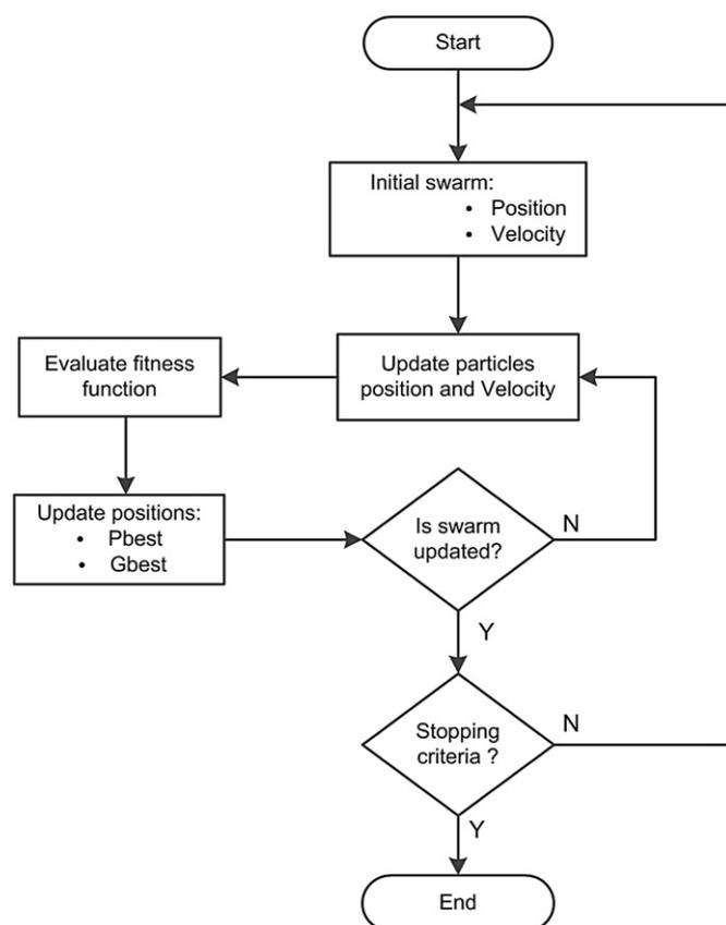
Fig. 1. PSP used algorithm.
